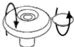
Для крепления листов поликарбоната термошайбами сверление отверстия в листе производится только под прямым углом для предотвращения перекосов и обеспечения изоляции крепления.
